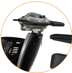
Dashboard behoudt positie bij stuurverstelling
