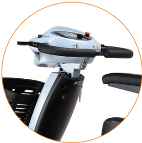
Dashboard behoudt positie bij stuurverstelling
